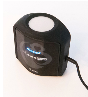
Rysunek 3.8. Kalibrator w pozycji pomiaru jasności otoczenia. Dioda zapala się co kilka sekund
